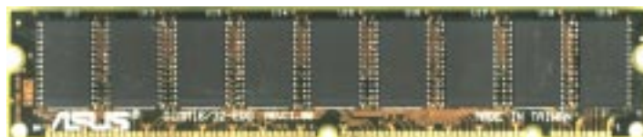
EDO DIMM-память с контролем четности (9 микросхем)
