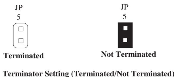
Ob die PCI-SC200 terminiert werden muß oder nicht, hängt von ihrer Position in der SCSI-Kette ab. Nur die Geräte an den beiden Enden der Kette müssen terminiert werden. Wenn Sie nur interne oder nur externe Geräte an die PCI-SC200 angeschlossen haben, dann müssen Sie die PCI-SC200 terminieren. Wenn Sie interne und externe Geräte angeschlossen haben, dürfen Sie die Karte nicht terminieren. Die Abbildungen auf der nächsten Seite veranschaulichen dies.
